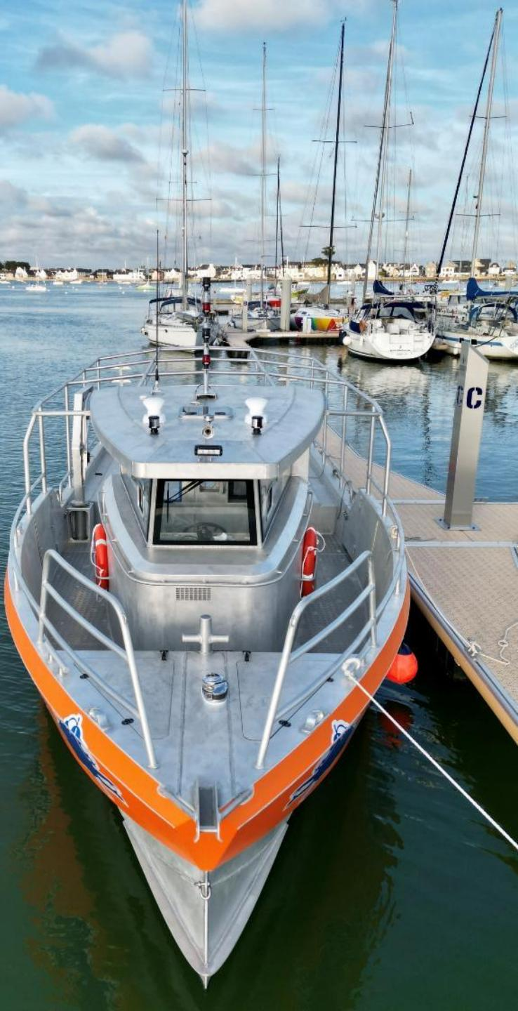
**Le PIXSEA® 1200**, conçu pour accueillir 32 plongeurs et leur pilote, dispose d'une cabine ouverte à l'avant, offrant un espace de pilotage abrité. À bord, des installations modulaires telles que des bancs et des porte-bouteilles peuvent être adaptées à des besoins spécifiques.
